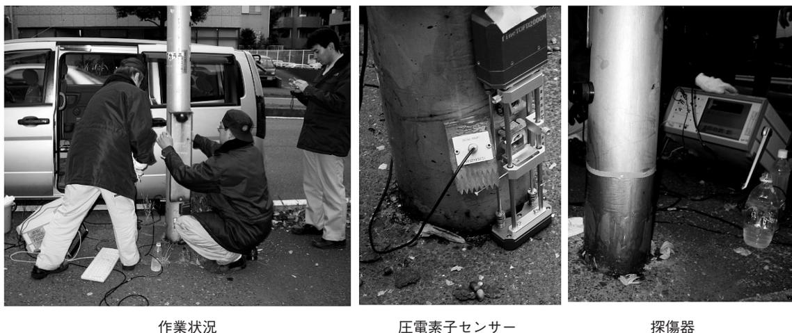
図2 圧電素子で発生させたガイドウエーブを使用した実機試験風景
