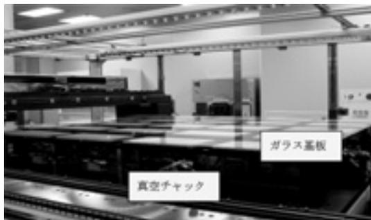
写真3 真空チャック上のガラス基板
