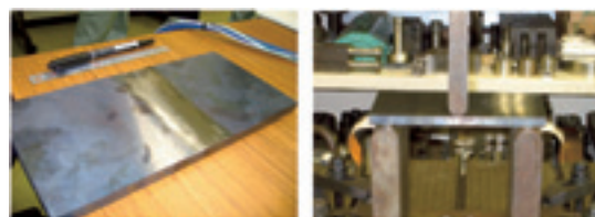
図4-2 試験片と3点曲げ疲労試験
