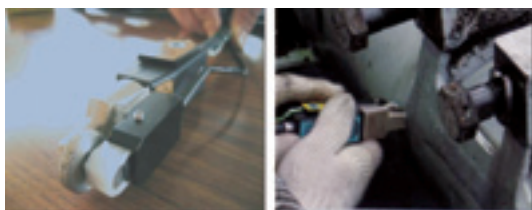
図2 プローブと台車枠探傷部位を探傷する様子
