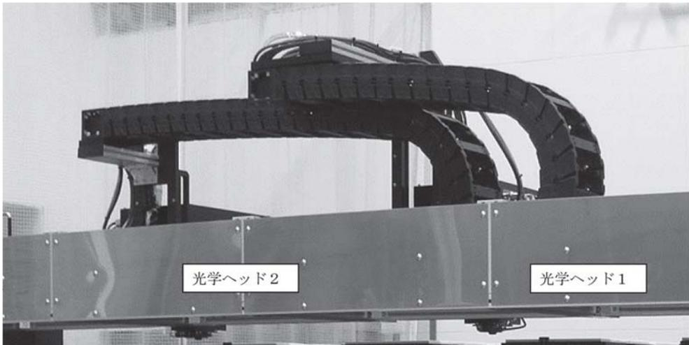
図4 ダブル光学ヘッド搭載時の外観
