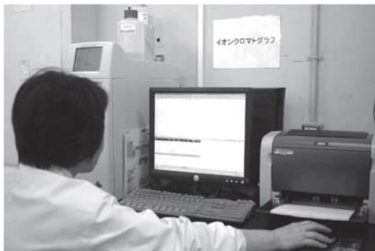
イオンクロマトグラフ装置による陰イオン同時分析
