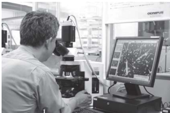
分散染色位相差顕微鏡によるアスベスト観察 （ご要望によりモニター画面を出力添付）
