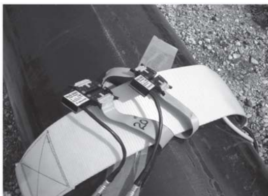
図23 Tモード用ガイドウェーブセンサの概要
