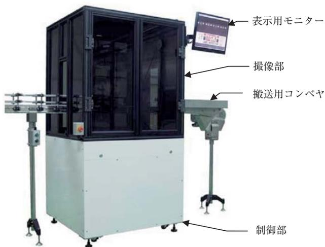
図58 新ラベル検査装置外観
