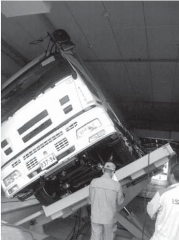
図4 車輛傾斜角測定装置試験状況写真
