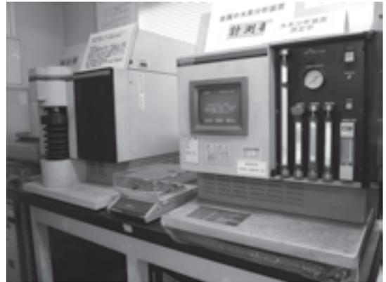
図 4.1 堀場製作所製 金属中の水素分析装置 EMGA-521
