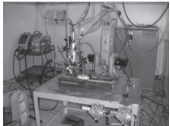
図7 多軸ロボットによるハイブリッド溶接の例
