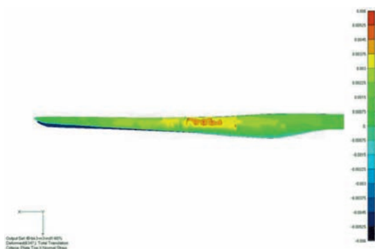
図3 ブレードのひずみ解析結果例
