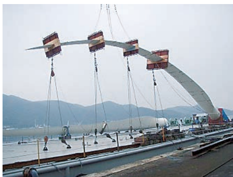
写真5 地上曲げ破壊試験
