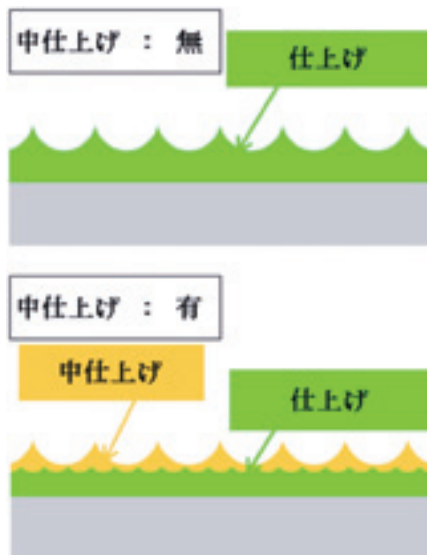
図5 中仕上げ加工
