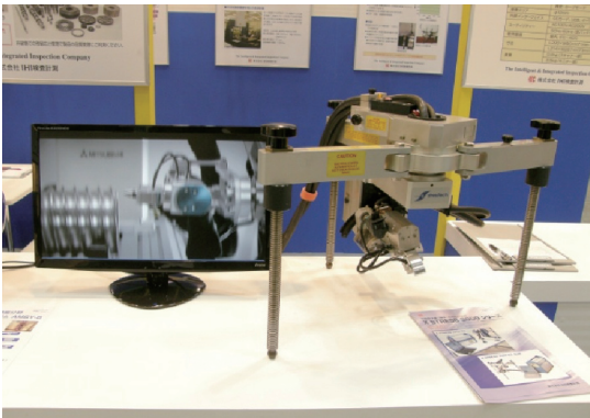
写真6 超小型 X線応力測定装置 XSTRESS 3000
