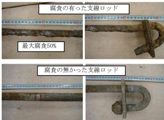
図11 腐食のあった掘削跡の支線ロッド
