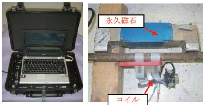
図3 ガイド波装置外観・Lモード用センサー設置状態
