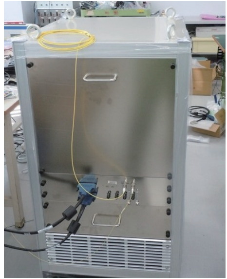
図 9 開発した FBG センサ用計測システム外観
