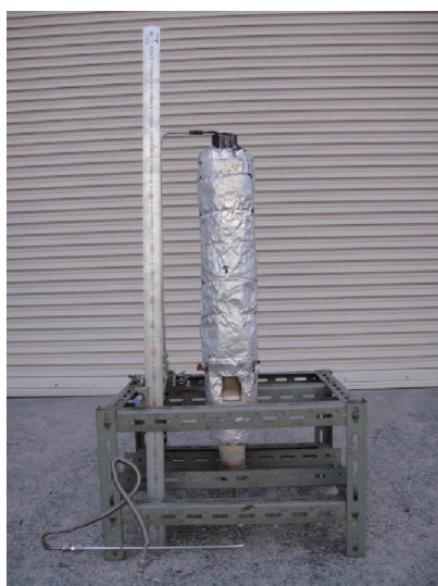
図 18 常圧石英製流動層燃焼炉外観
