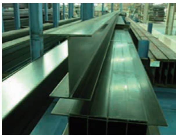
図 1 住宅向け梁用 H 型鋼
