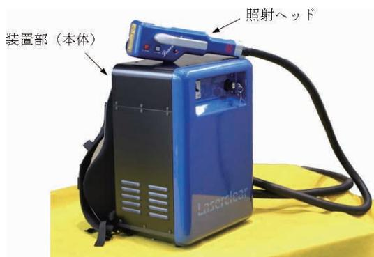
図8 バックパック型レーザークリア試作品の外観
