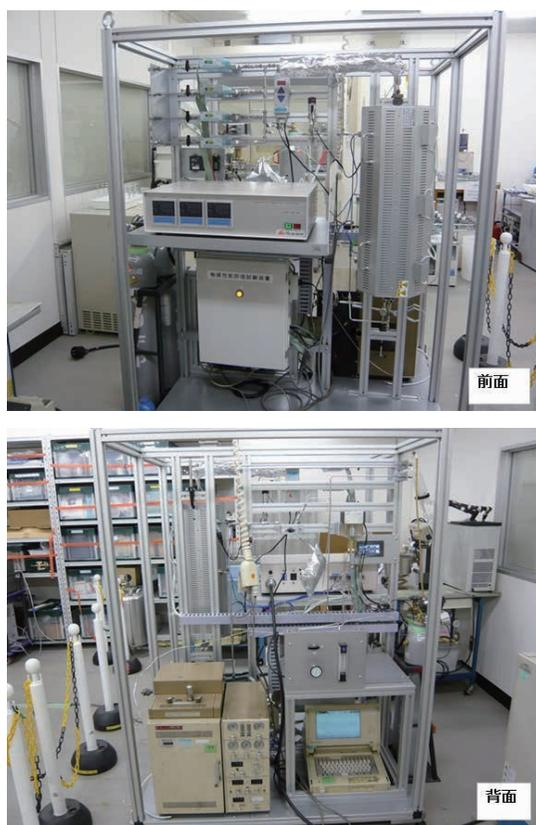
図 2 触媒性能評価装置外観
