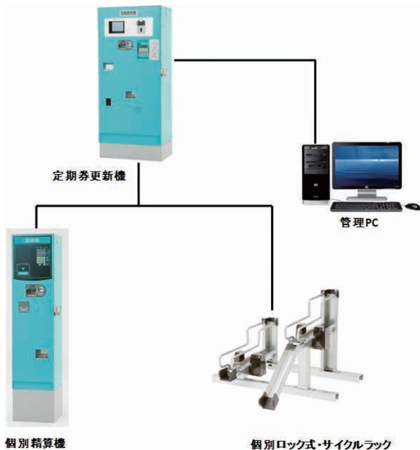
図3 個別ロック式・駐輪場システム 構成
