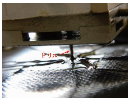
図6 穿孔中の様子 ( \phi 2.57\text{mm} ゲージ)
