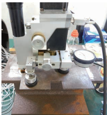
図5 試験体上の穿孔装置
