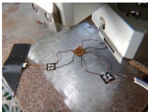
図4 穿孔前 ( \phi 2.57\text{mm} ゲージ NO.1)
