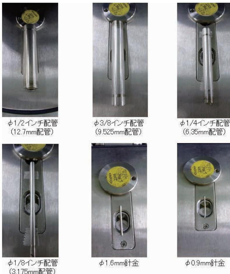
写真4 各試料とX線透過窓との配置
