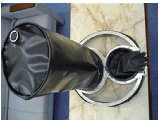
図 4 ORVR-SHED 給油ポート内部
