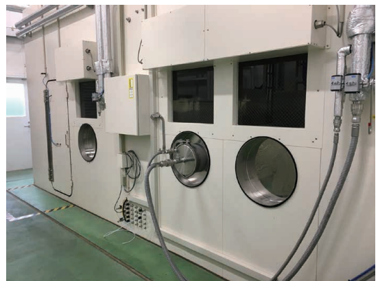
図 3 ORVR-SHED 給油ポート (提供：八千代工業株式会社)
