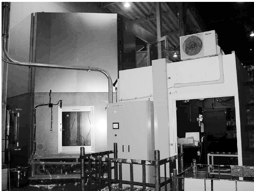
図6 メリーゴーランド式蛍光浸透探傷装置 (導入事例)
