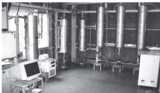
図19 脱硝触媒性能評価試験設備
