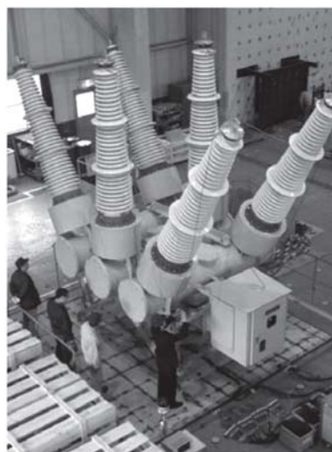
図49 電流遮断器振動試験
