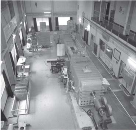
図55 キャビテーション水槽（観測胴部）
