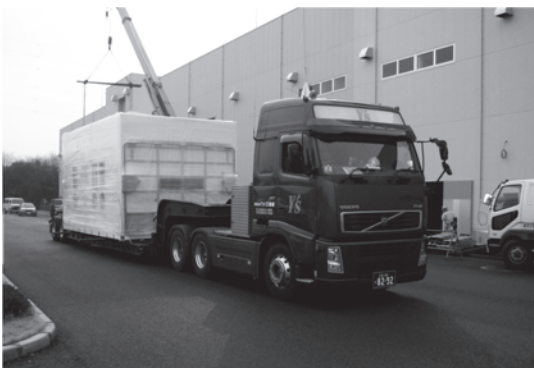
図3 75m 3 VT-SHED 設備 (現地搬入時)
