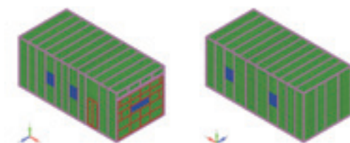
図1 ケース7の解析モデル図 (容量75m 3 、SUS304の板厚0.8mm) - 鳥瞰図
