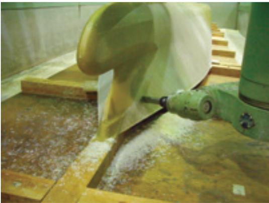
写真2 NC 切削機加工写真 (船首端部仕上切削)
