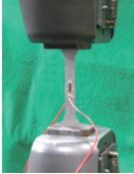
図4 ひずみゲージによる測定状況
