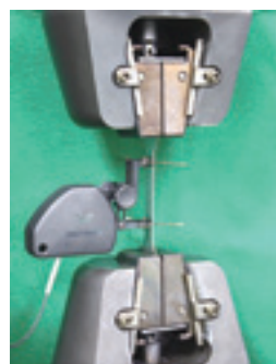
図3 クリップ式伸び計による測定状況
