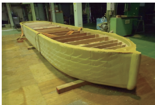
図7 模型船素材（フレキシブル外型）
