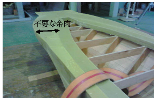
図4 従来の模型船素材の不要な余肉
