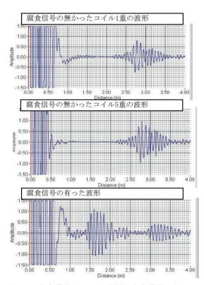
図 12 腐食信号があった波型と腐食信号の無かった波型及び5重コイルとの比較
