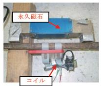
図3 ガイド波装置外観・Lモード用センサー設置状態
