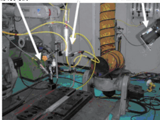
図8 亜鉛メッキ鋼板の重ね溶接の高速度カメラによる観察例
