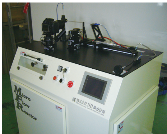
図 13 マイクロフローリアクタ試験装置 外観
