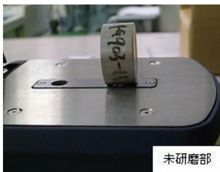
写真3 ステンレス鋼棒材を用いた表面状態の比較
