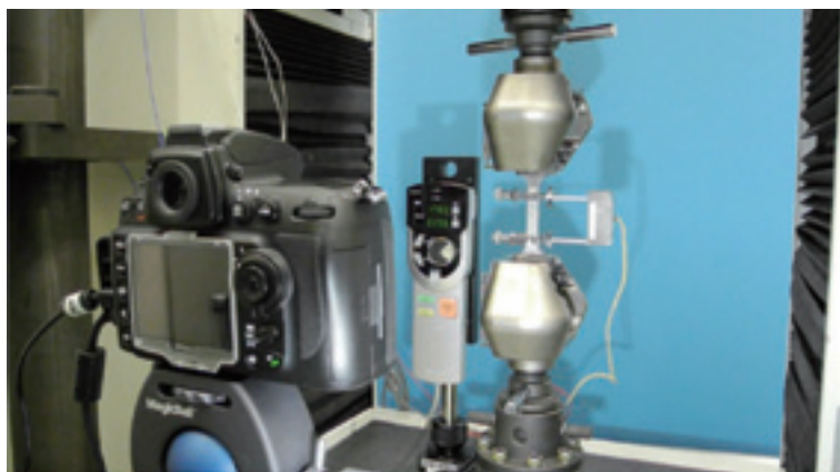
図 4 引張試験状況
