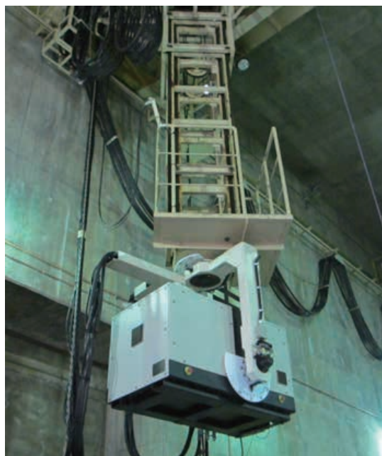
図6 IHI 相生工場向け X線発生装置 (全景)
