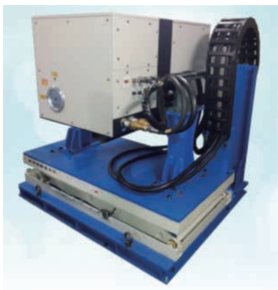
図 1 IIC 愛知事業所の X 線発生装置 (0.95MeV)
