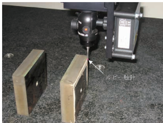
写真 2 CMM による測定の様子 (Courtesy of The Open University)
