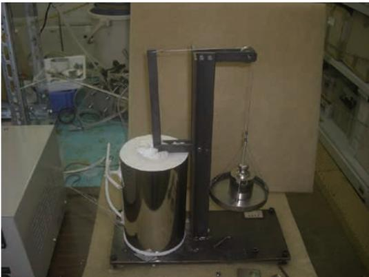
写真2 曲げ試験装置（加熱炉設置）
