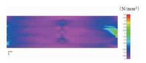
図9 ケース7の床版下面の最大主応力
