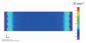
(b) 床版上面の最大主応力 図7 ケース2の解析結果
