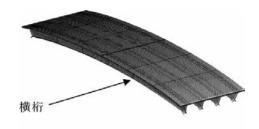
最大鉛直方向変位15mm (a)変形状態
