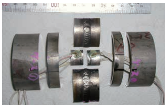
図2 実合せ溶接部の残留応力測定
