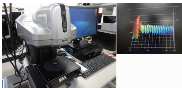
図 14 測定機外観とネジのプロファイル
