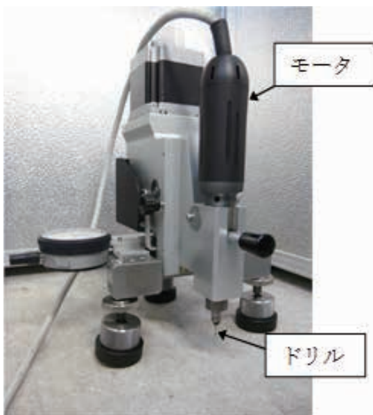
図10 プラスチック用穿孔装置 (モータを取り付けた状態)
