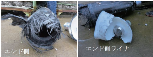
(b) エンド側破断面 (c) エンド側ライナ
