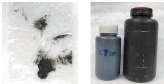
図1 分析試料(左：目詰まり物質(2cm大)、右：C重油および再生油)
