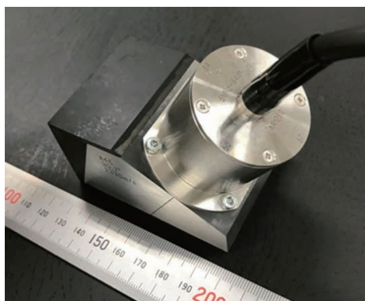
図3 リング分割型アニュラアレイ探触子の外観
