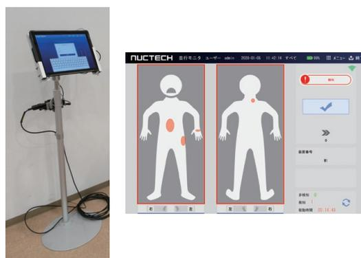
図6 並行モニター(左図:外形、右図:画面)
