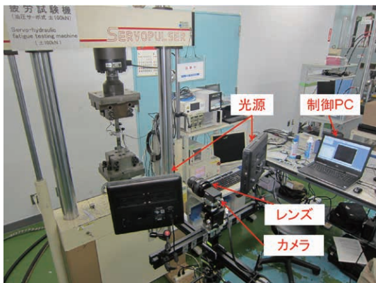
図2 DIC装置設置全体
