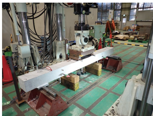
図13 塗装後の模擬RC床版
