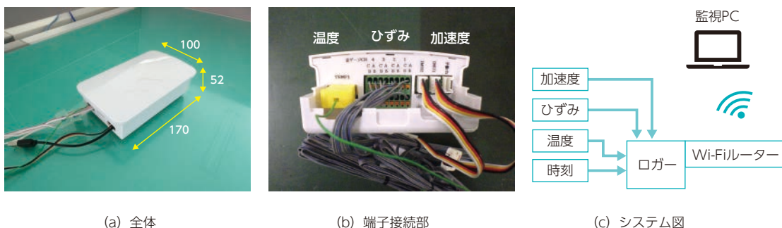
図3 初期モデルの外観とシステム図
