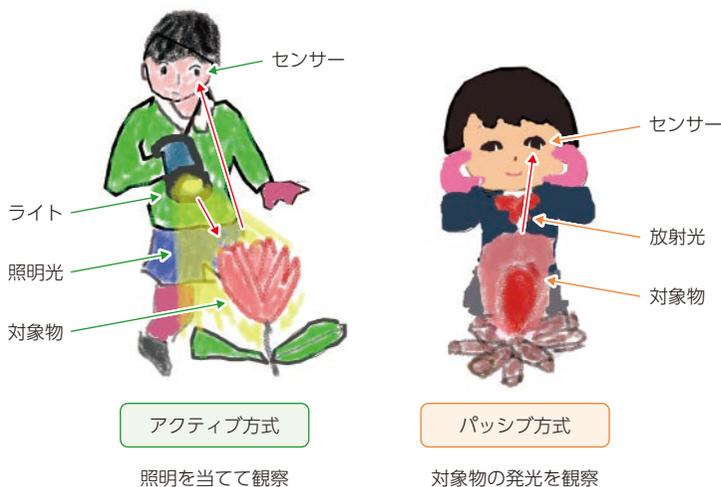
図6 アクティブ方式とパッシブ方式
