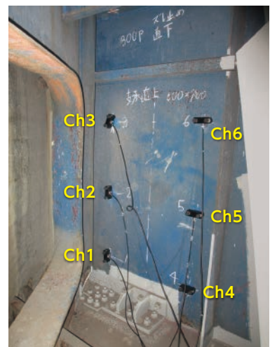
図5 計測箇所cにおける計測風景と設置センサのチャンネル番号の対応関係
